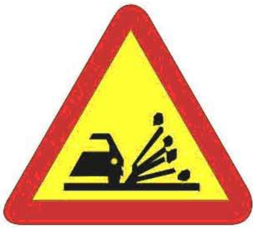
TP-28 PROYECCION DE GRAVILLA
