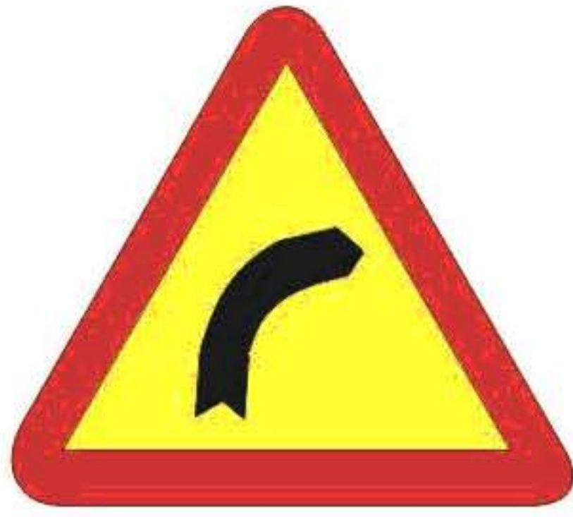
TP-13 a CURVA PELIGROSA HACIA LA DERECHA
