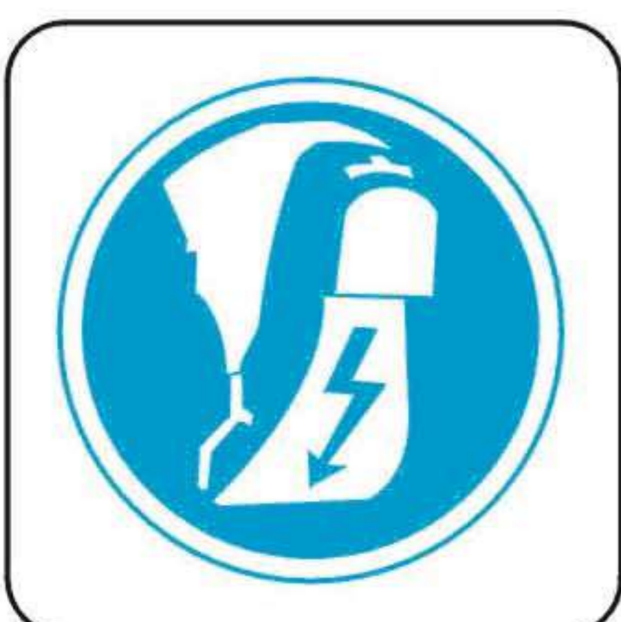
SO-210 USO OBLIGATORIO DE CALZADO ANTIESTATICO
